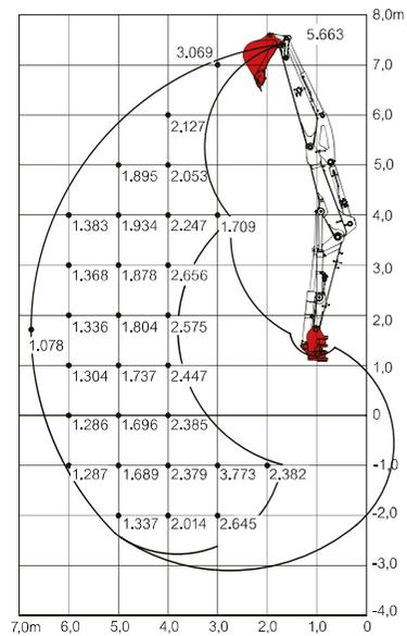
Die Lasten im Diagramm liegen innerhalb 87% der hydraulischen Hublast und innerhalb 75% der Kipplast.
